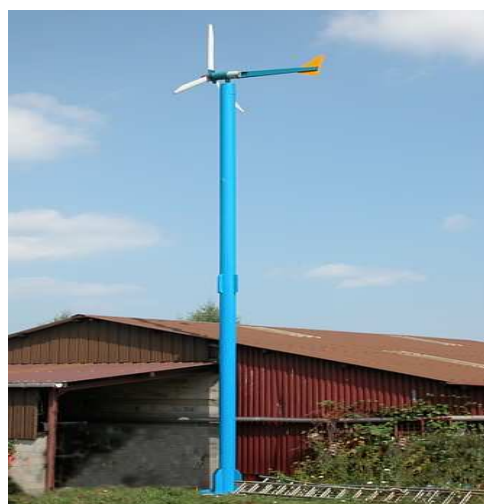
Éolienne 1 kW 48 volts (2 500 €)
